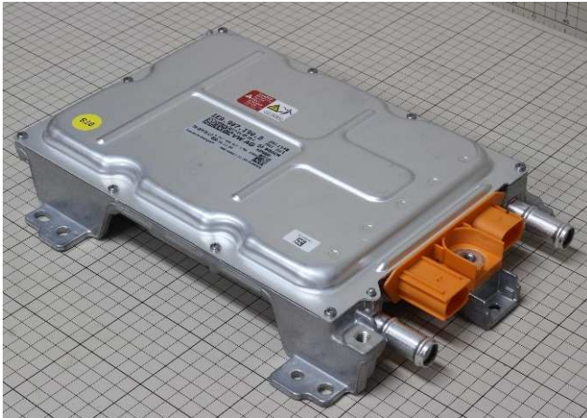
搭載DCDCコンバータ外観
