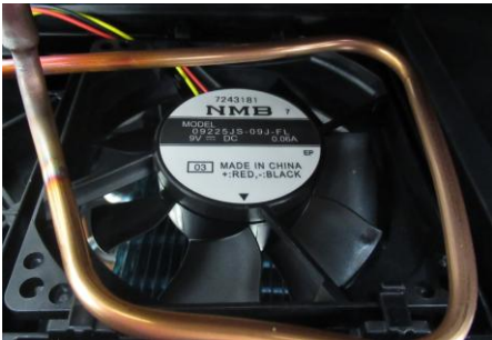
コンプレッサのファン (NMB Technologies製09225JS-09J-FL)
