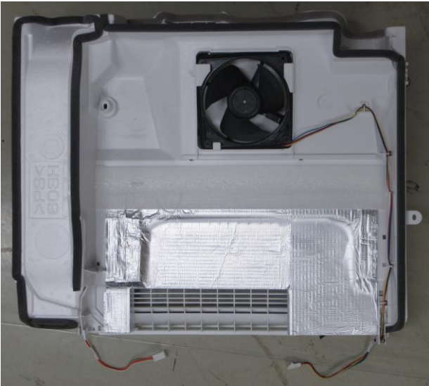
冷凍庫背面内壁
