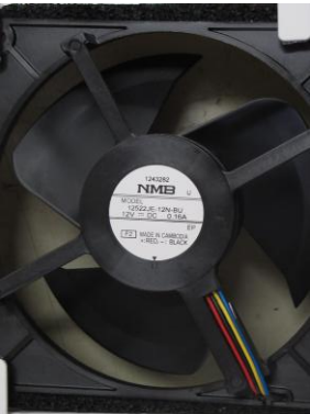
冷凍室ファン (NMB Technologies製12522JE-12N-BU)
